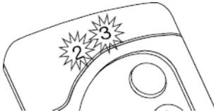
**4.** Le contrôleur signale que le dispositif est retiré correctement du réseau (deux diodes externes allumées pendant 2-3 s).
